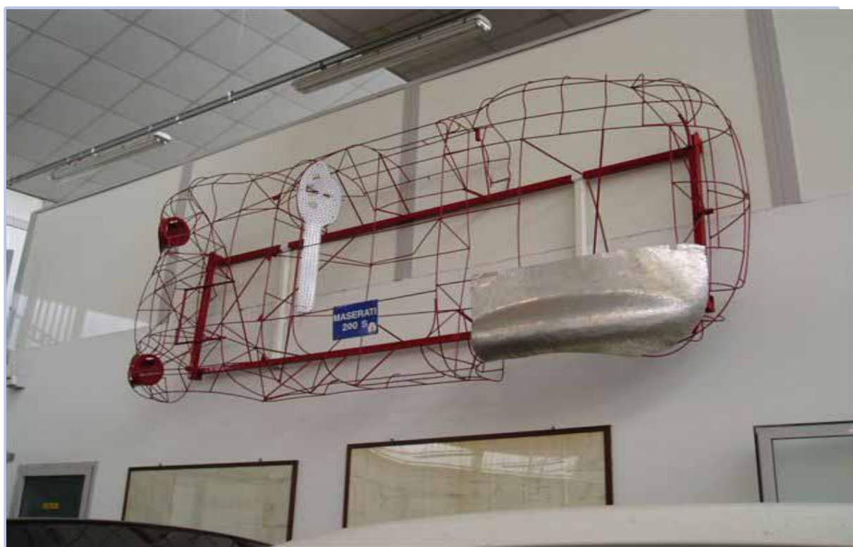
Fig. 1 – maschera di assemblaggio carrozzeria Maserati “200S” ( carrozzeria Campana )
